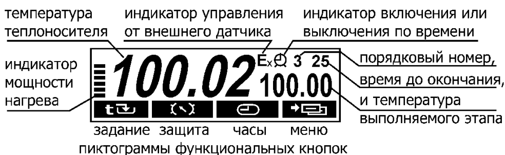
Рисунок 5 — Дисплей в режиме регулирования по программе
