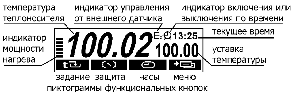
Рисунок 4 — Дисплей в режиме регулирования по уставке
